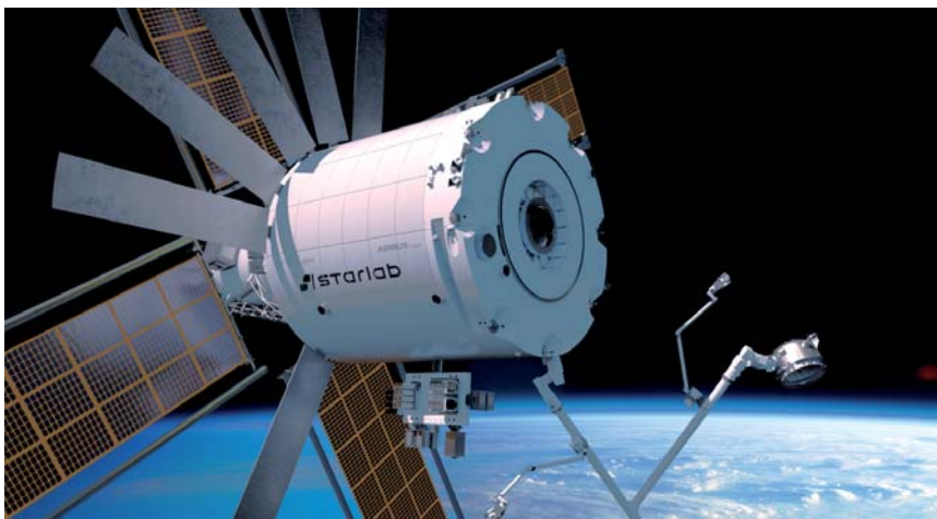
Die Starlab Space Stations (Voyager, Airbus, Mitsubishi, MDA, Palantir) sind geplante kommerzielle Raumstationen in erdnaher Umlaufbahn (LEO) mit einem Volumen von etwa 450 m 3 . Die Starlab-Raumstationen sollen mit dem Trägersystem SpaceX Starship in einem einzigen Start pro Station in den LEO gebracht werden.
