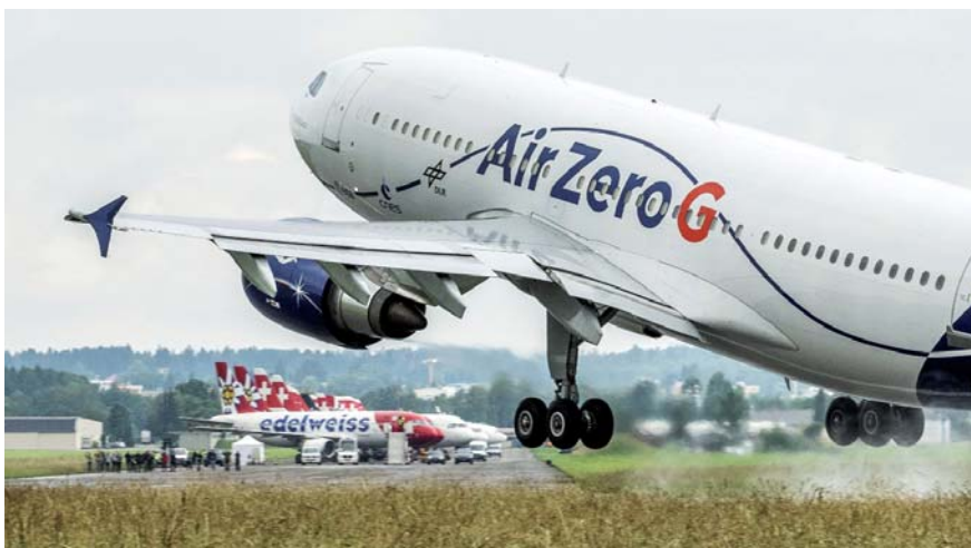
Die A310 ZERO-G von Novespace ist ein Forschungsflugzeug für Parabelflüge, das im Rahmen des Swiss Parabolic Flight Program vom Flugplatz Dübendorf aus eingesetzt wird.
