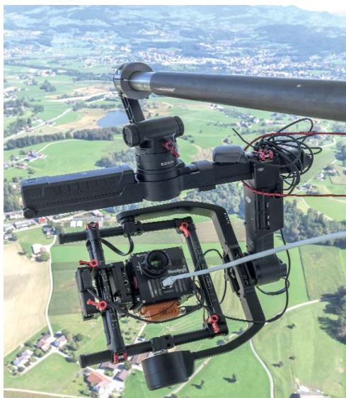
Am UZH Space Hub werden durch des Geographische Institut Fernerkundungs-Sensoren zur Detektion von Plastikbestandteilen im Wasser entwickelt, die zur Behebung der Plastikverschmutzung der Meere beitragen werden. Diese werden hier auf einer Forschungsmission mit dem Zeppelin NT getestet.
