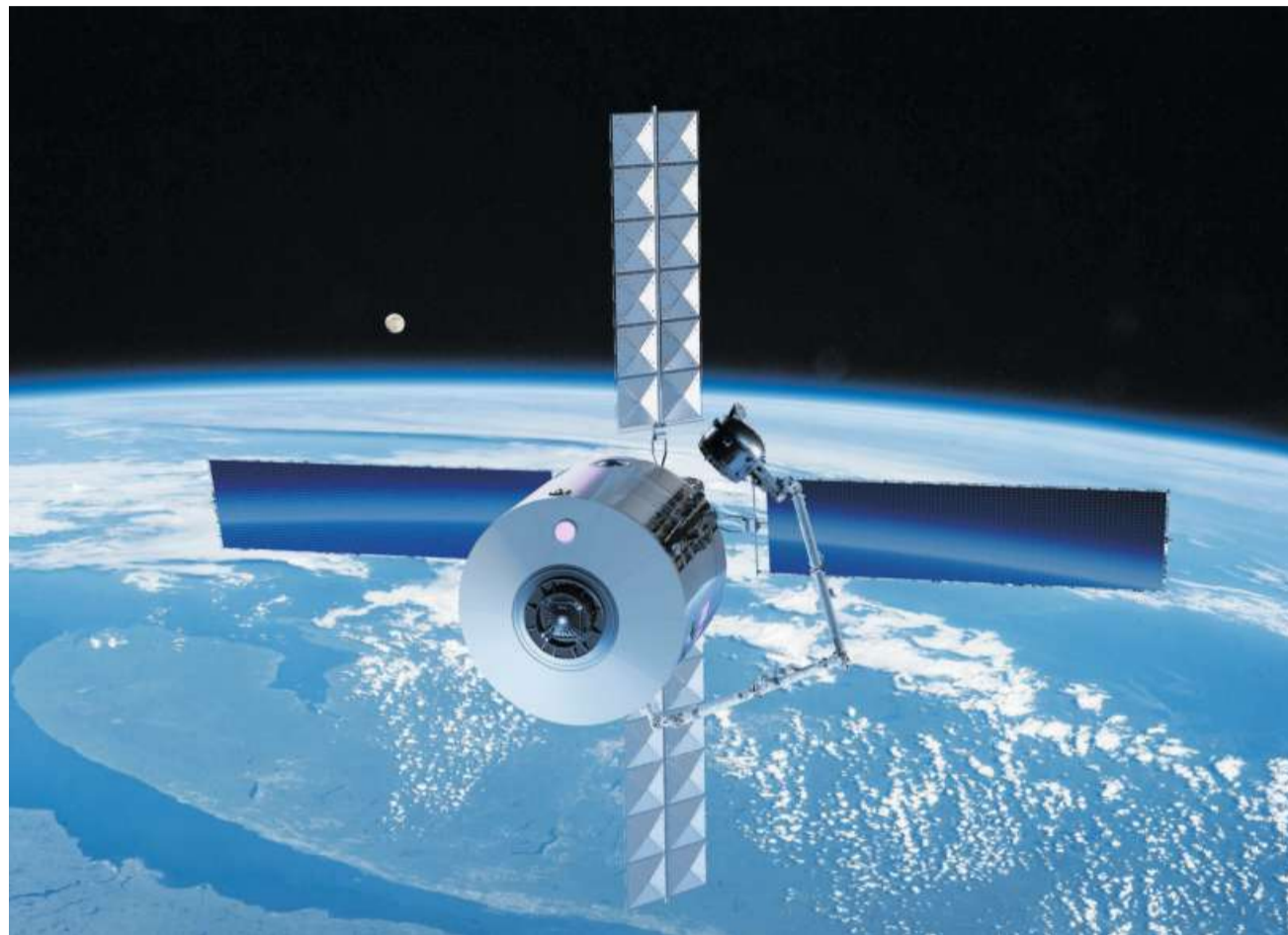
Aus Edelstahl und in einem Stück ins Weltall befördert: der Satellit von Starlab.
